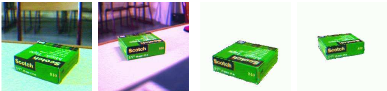
FIG. 3.7 – Les deux images de gauche montrent les vues de référence (réelles) d'une boîte. Les deux images de droite montrent les deux vues de synthèse du modèle de cette boîte, pour la même projection que les deux caméras réelles. La façon dont ce modèle a été obtenu est abordée plus loin.
