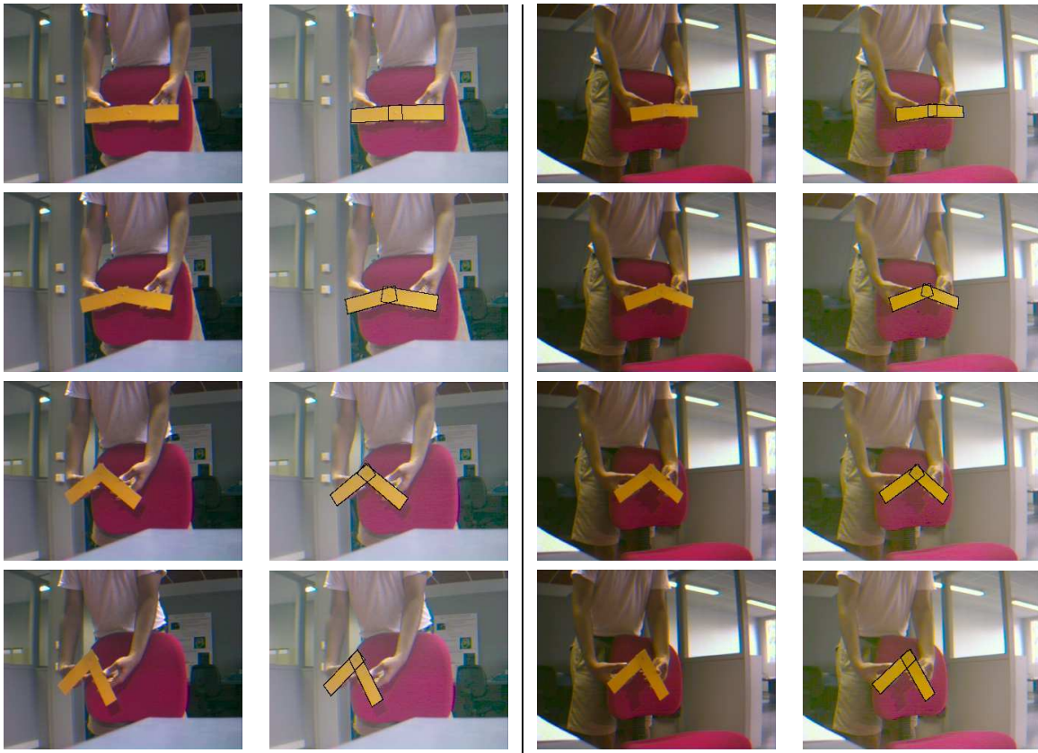
FIG. 2.6 – Suivi d'un objet articulé simple. La partie gauche de la figure correspond à la première caméra et la partie droite à la seconde caméra. Dans chaque partie se trouve à gauche l'image vidéo originale et à droite la même image avec le modèle positionné grâce aux paramètres trouvés.
