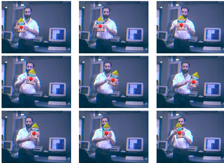
FIG. 3.3 – De gauche à droite et de haut en bas : exemple d'incrustation d'images de synthèse dans une scène réelle. On remarque dans les dernières images l'absence de gestion des problèmes d'occultation
