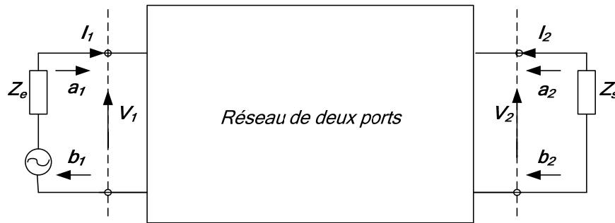
Figure 2.19 Description du réseau de deux ports
