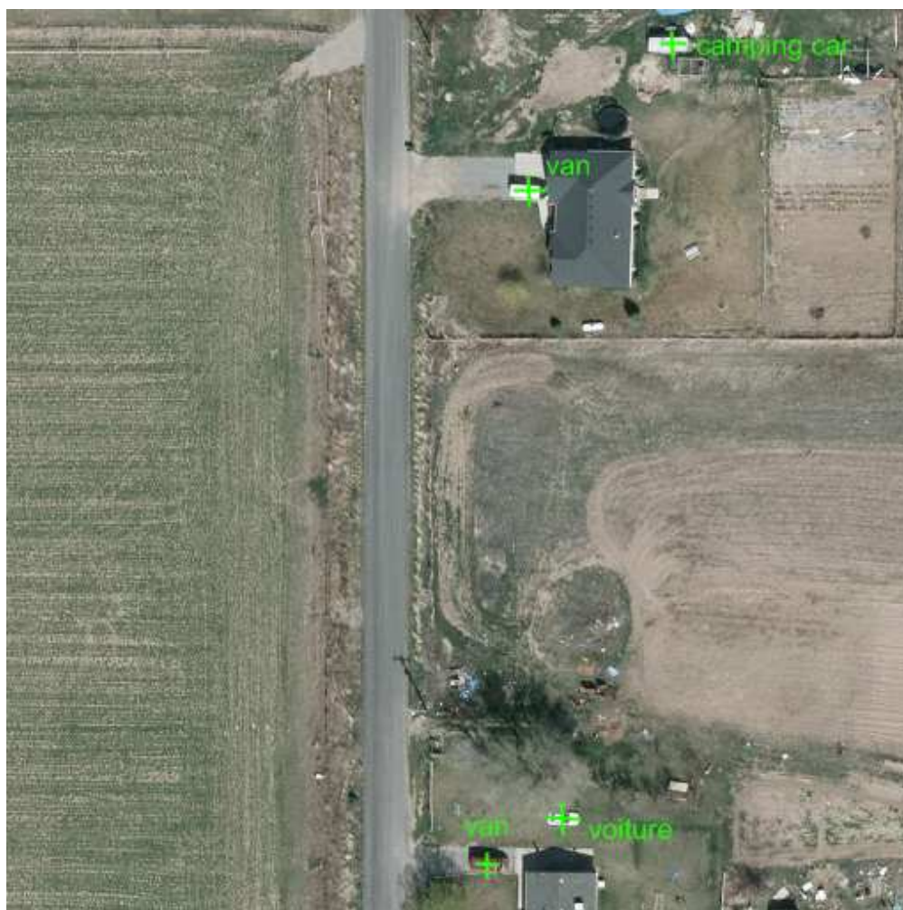
FIGURE 1.1 – Illustration de la problématique de Détection. Deux vans, une voiture et un camping car ont été détectés dans cette image, leurs positions respectives sont marquées d'une croix.
