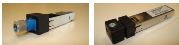
Figure 53 : Des modules SFP 100 Mbit/s mono-fibre de marque Diemount (gauche) et bi-fibre de marque Infineon (droite)
