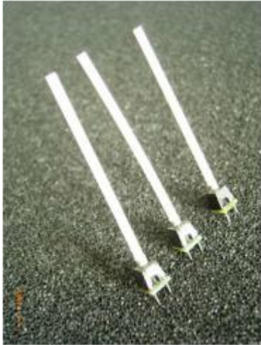
Figure 48 : Photographie de DEL avec pigtail commercialisées par la société Diemount
