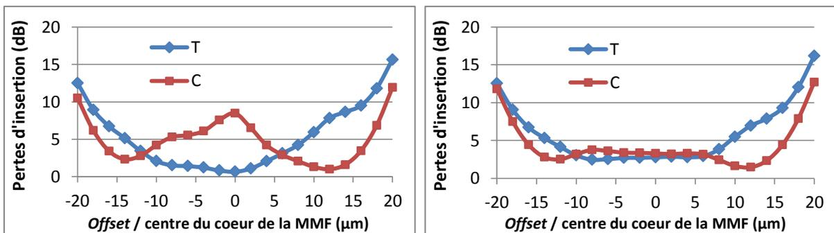
Figure 154 : Pertes d'insertion du coupleur 2x2, pour des champs d'entrée gaussiens issus d'une fibre SMF et avec différents offsets par rapport au centre du cœur de la MMF, à 850 nm (gauche) et 1300 nm (droite)
