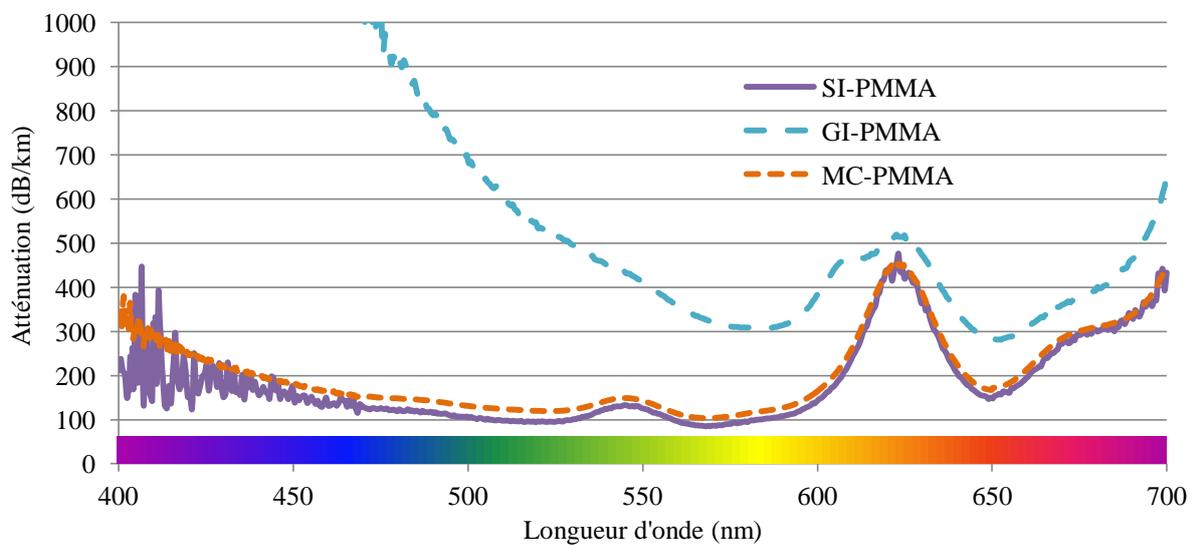
Figure 28 : Atténuation des fibres en PMMA
