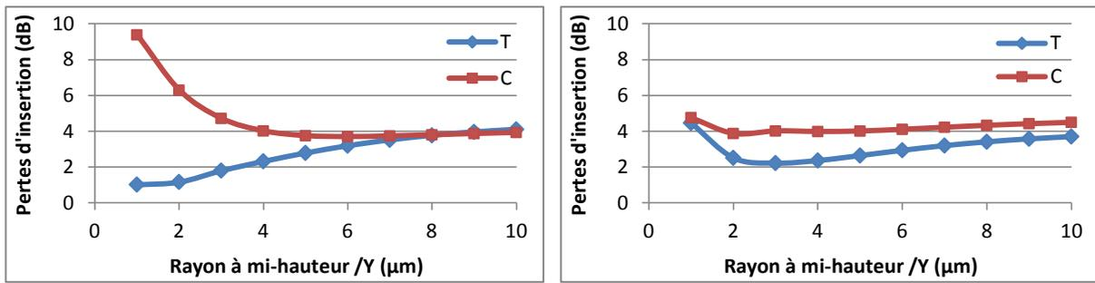
Figure 127 : Pertes d'insertion du coupleur 2x2, pour des champs d'entrée gaussiens, à base elliptique, centrés sur le cœur de la MMF et de rayons à mi-hauteur différents  $Y = X/3$ , à 850 (gauche) et 1300 nm (droite)
