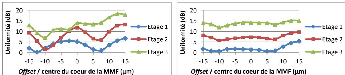
Figure 162 : Uniformité de la puissance en sortie des coupleurs  $2 \times 2$ ,  $4 \times 4$  et  $8 \times 8$ , pour un champ d'entrée gaussien à base elliptique ( $X = 6 ; Y = 2$ ) avec différents *offsets* par rapport au cœur de la MMF, à 850 (gauche) et 1300 nm (droite)
