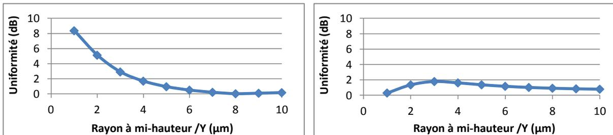
Figure 129 : Uniformité de la puissance en sortie du coupleur 2x2, pour des champs d'entrée gaussiens, à base elliptique centrés sur le cœur de la MMF, de rayons à mi-hauteur différents  $Y = X/3$  à 850 (gauche) et 1300 nm (droite)
