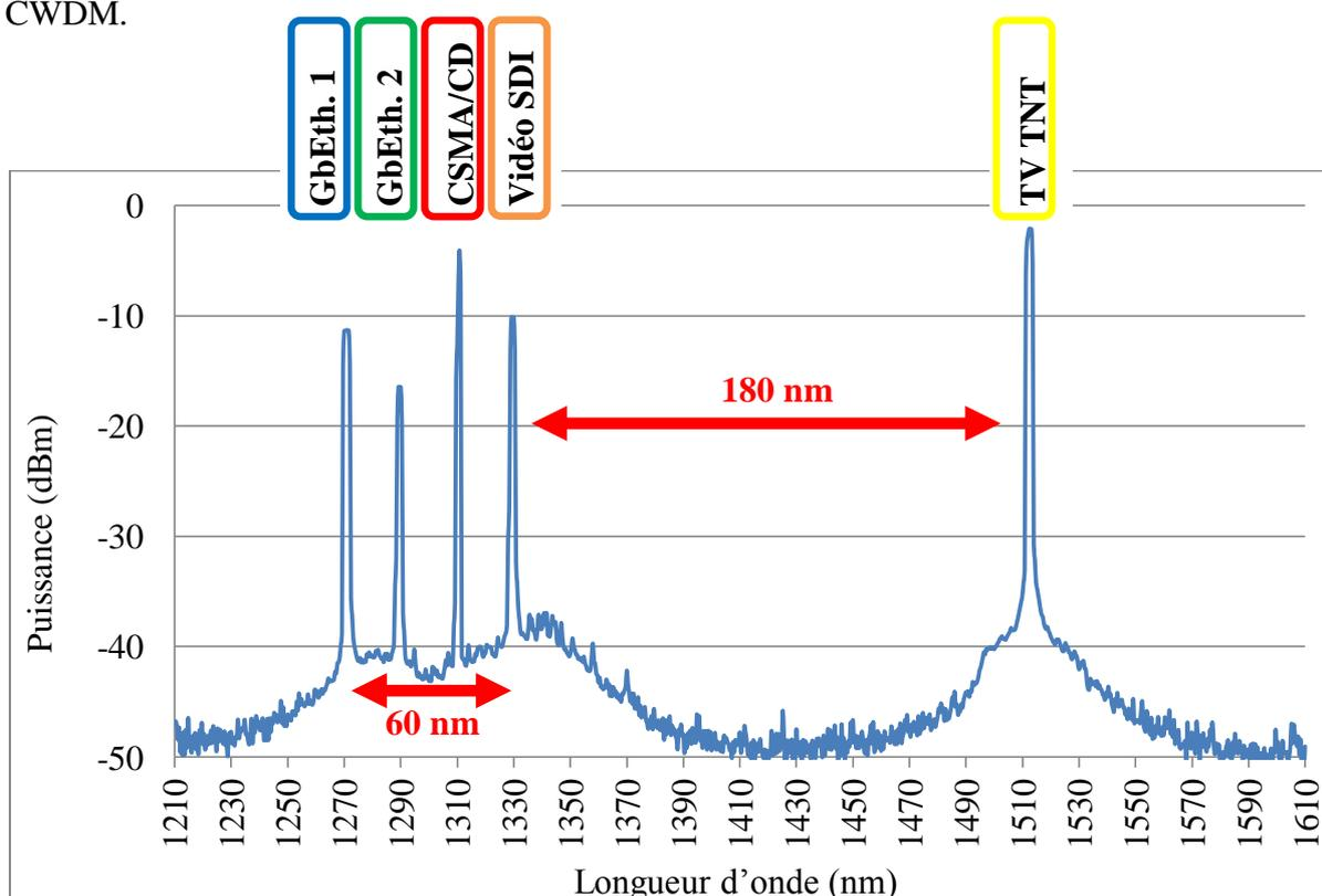
Figure 66 : Plan d'onde des services implémentés
