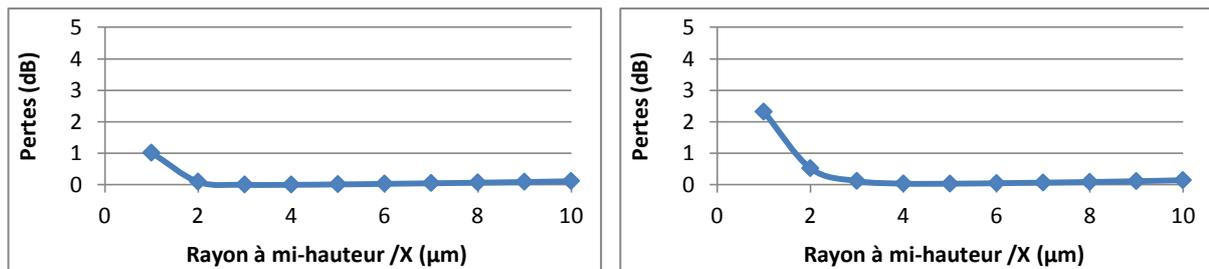
Figure 125 : Pertes en excès du coupleur 2x2, pour des champs d'entrée gaussiens, à base elliptique, centrés sur le cœur de la MMF et de rayons à mi-hauteur différents  $X = Y/3$ , à 850 (gauche) et 1300 nm (droite)
