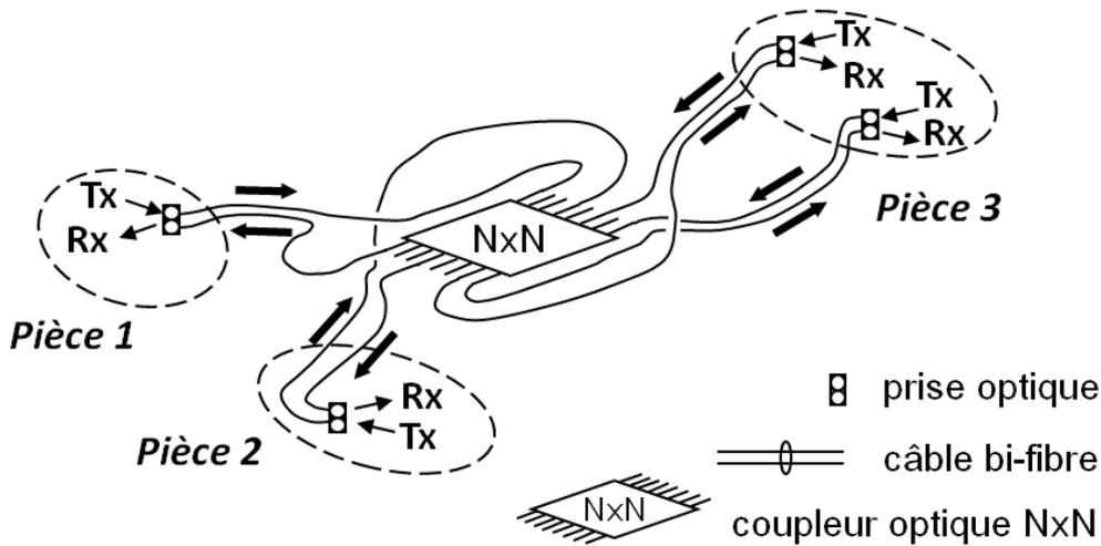
Figure 16 : Infrastructure optique en étoile passive
