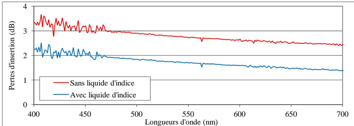
Figure 47 : Pertes d'insertion d'une connexion à base de connecteurs F-05 et d'un raccord dédié
