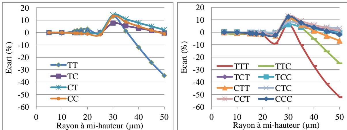
Figure 134 : Ecart de puissance pour les différents chemins des coupleurs  $4 \times 4$  (gauche) et  $8 \times 8$  (droite) entre simulations et calcul matriciel, à 1300 nm
