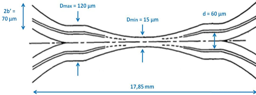
Figure 80 : Caractéristiques géométriques du coupleur 2x2 à fusion – étirage
