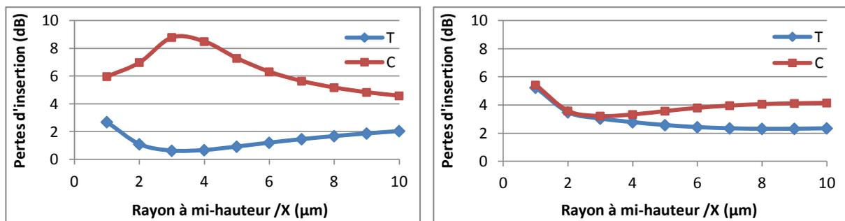
Figure 124 : Pertes d'insertion du coupleur 2x2, pour des champs d'entrée gaussiens, à base elliptique, centrés sur le cœur de la MMF et de rayons à mi-hauteur différents  $X = Y/3$ , à 850 (gauche) et 1300 nm (droite)
