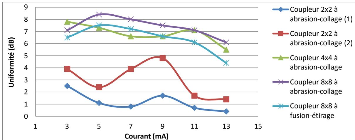
Figure 170 : Uniformité des coupleurs N×N face à un VCSEL à 1310 nm, en fonction du courant de polarisation
