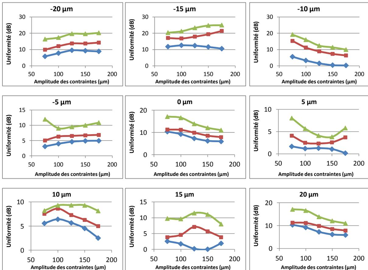
Figure 169 : Uniformité de la puissance en sortie des coupleurs 2×2, 4×4 et 8×8, pour un champ issu d'une fibre SMF, injecté avec *offset* dans le brasseur de modes puis propagé dans le coupleur, à 850 nm
