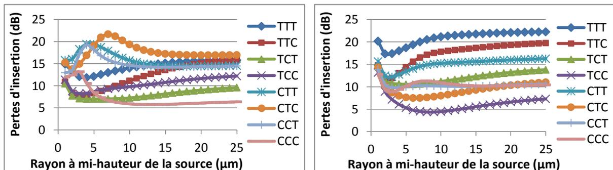
Figure 136 : Pertes d'insertion du coupleur 8×8, pour des champs d'entrée gaussiens, centrés sur le cœur de la MMF et de rayons à mi-hauteur différents, à 850 (gauche) et 1300 nm (droite)
