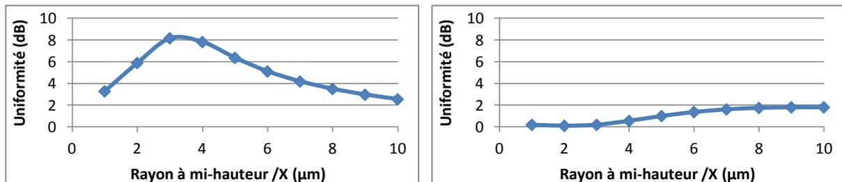
Figure 126 : Uniformité de la puissance en sortie du coupleur 2x2, pour des champs d'entrée gaussiens à base elliptique centrés sur le cœur de la MMF, de rayons à mi-hauteur différents  $X = Y/3$  à 850 (gauche) et 1300 nm (droite)
