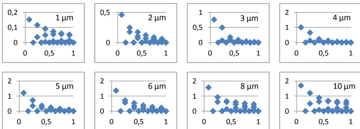
Figure 116 : Décomposition modale d'un champ gaussien, à base elliptique, pour différents rayons à mi-hauteur suivant l'axe transversal X, et Y = 3X, à 1300 nm
