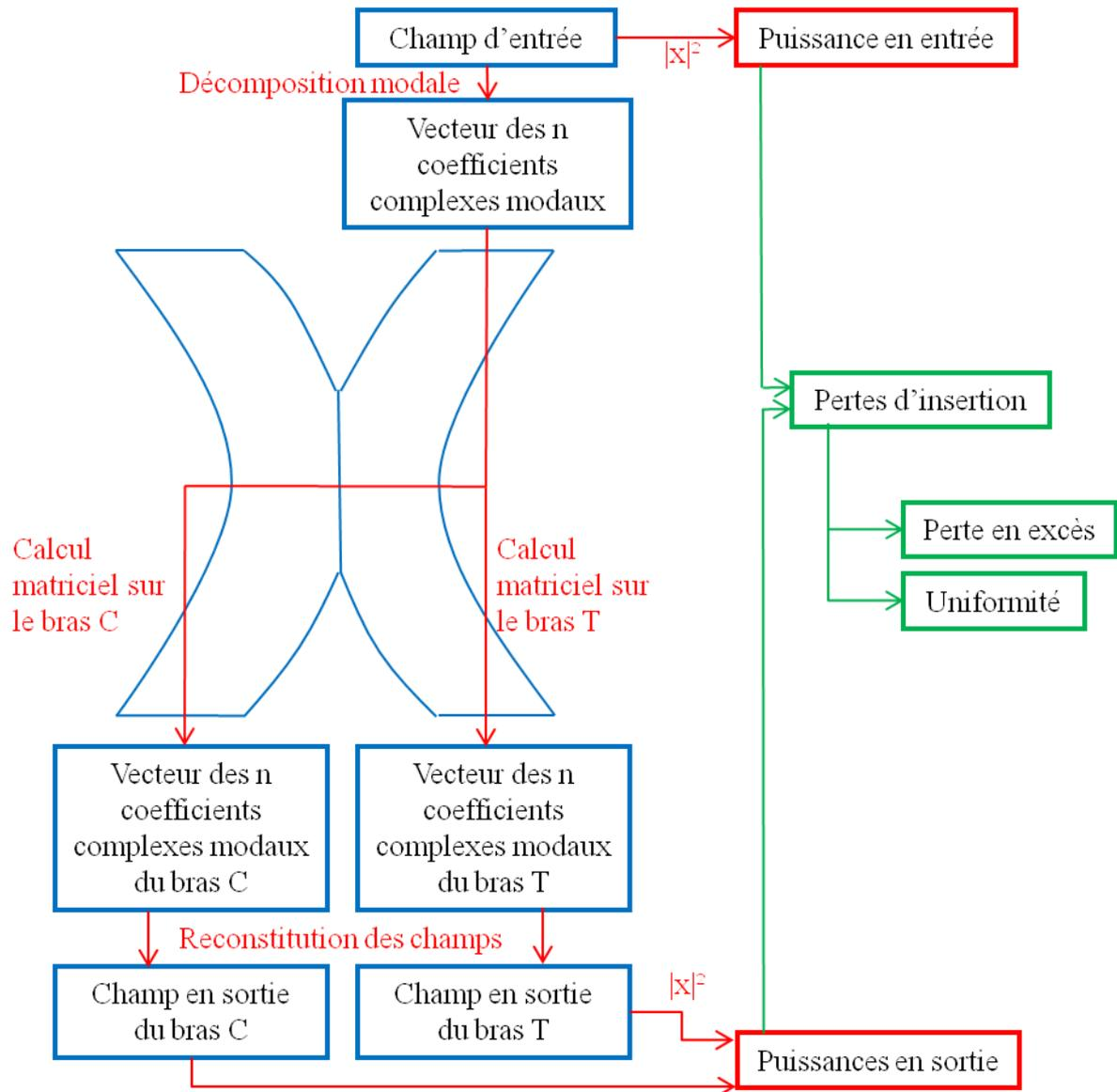
Figure 119 : Algorithme de calcul du programme implémenté
