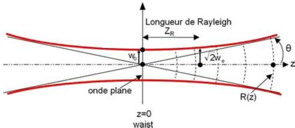
Figure 102 : Profil transversal du mode gaussien fondamental se propageant suivant l'axe optique  $z$
