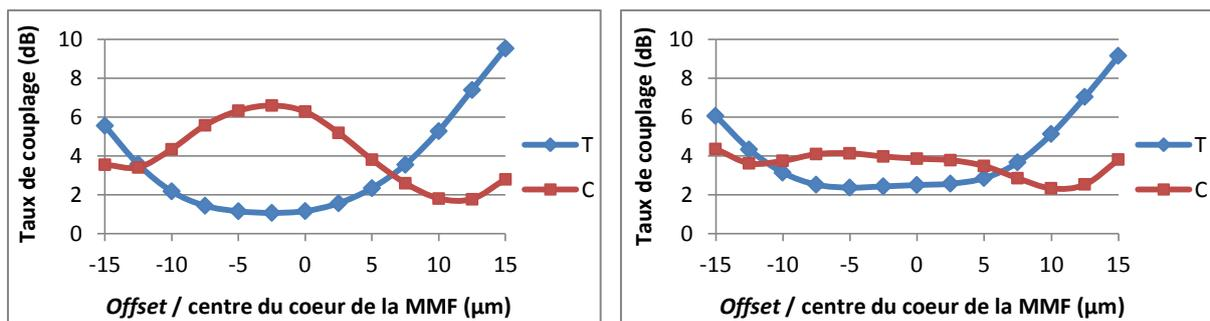
Figure 161 : Pertes d'insertion du coupleur  $2 \times 2$ , pour un champ d'entrée gaussien à base elliptique ( $X = 6 ; Y = 2$ ), avec différents *offsets* suivant X par rapport au cœur de la MMF, à 850 (gauche) et 1300 nm (droite)
