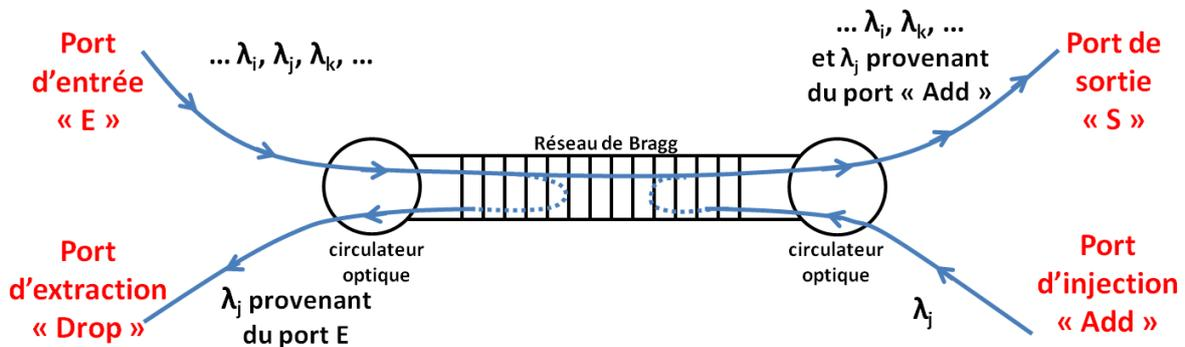
Figure 10 : Schéma du principe du filtre de type OADM à base de réseau de Bragg
