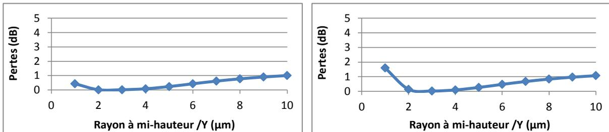
Figure 128 : Pertes en excès du coupleur 2x2, pour des champs d'entrée gaussiens, à base elliptique, centrés sur le cœur de la MMF et de rayons à mi-hauteur différents  $Y = X/3$ , à 850 (gauche) et 1300 nm (droite)
