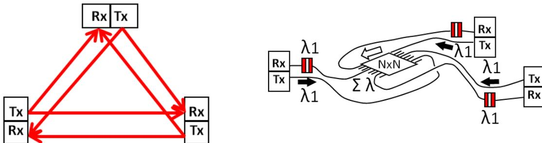
Figure 23 : Structure et implémentation de la liaison multipoint à multipoint
