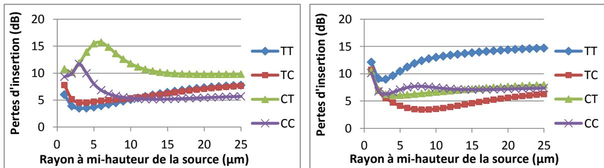
Figure 135 : Pertes d'insertion du coupleur 4×4, pour des champs d'entrée gaussiens, centrés sur le cœur de la MMF et de rayons à mi-hauteur différents, à 850 (gauche) et 1300 nm (droite)
