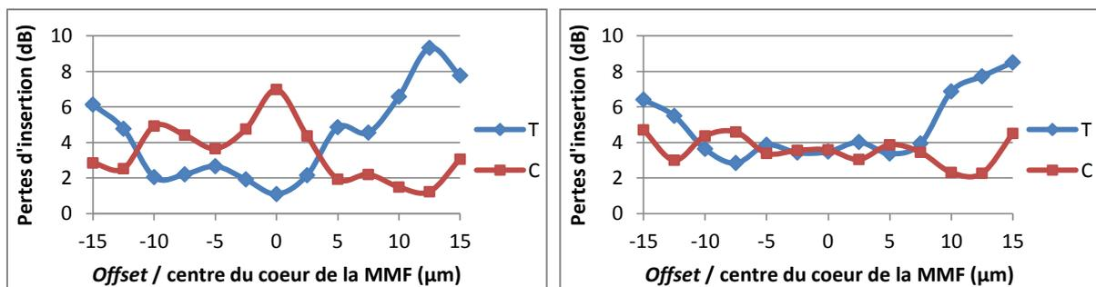
Figure 158 : Pertes d'insertion du coupleur 2x2, pour un champ d'entrée gaussien à base elliptique ( $X = 2 ; Y = 6$ ), avec différents *offsets* par rapport au cœur de la MMF et suivant l'axe X, à 850 (gauche) et 1300 nm (droite)
