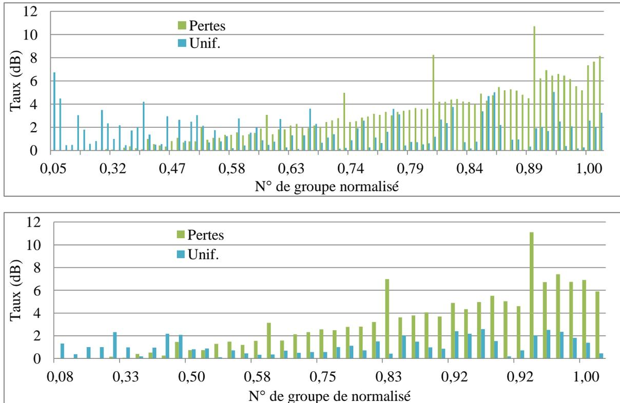
Figure 97 : Comportement modal du modèle : pertes en excès et uniformité à 850 (haut) et 1300 nm (bas)
