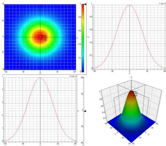
Figure 101 : Représentation 2D et 3D d'un champ gaussien
