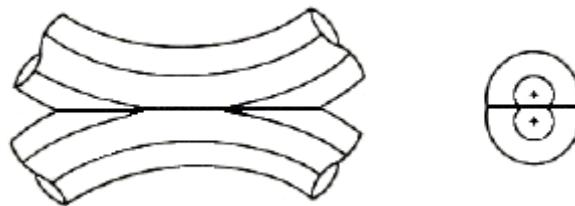
Figure 6 : Schéma du coupleur 2×2 à abrasion – collage et coupe transversale au col du coupleur [8]
