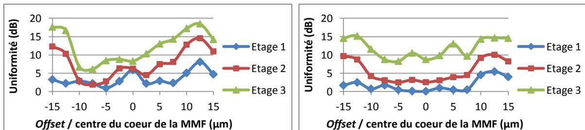
Figure 159 : Uniformité de la puissance en sortie des coupleurs 2x2, 4x4 et 8x8, pour un champ d'entrée gaussien à base elliptique ( $X = 2 ; Y = 6$ ) avec différents *offsets* par rapport au cœur de la MMF à 850 (gauche) et 1300 nm (droite)
