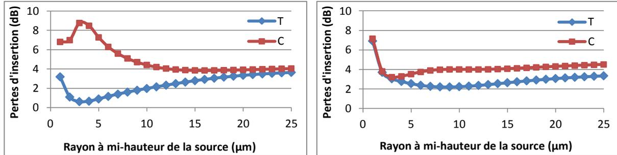
Figure 120 : Pertes d'insertion du coupleur 2×2, pour des champs d'entrée gaussiens, centrés sur le cœur de la MMF et de rayons à mi-hauteur différents, à 850 (gauche) et 1300 nm (droite)
