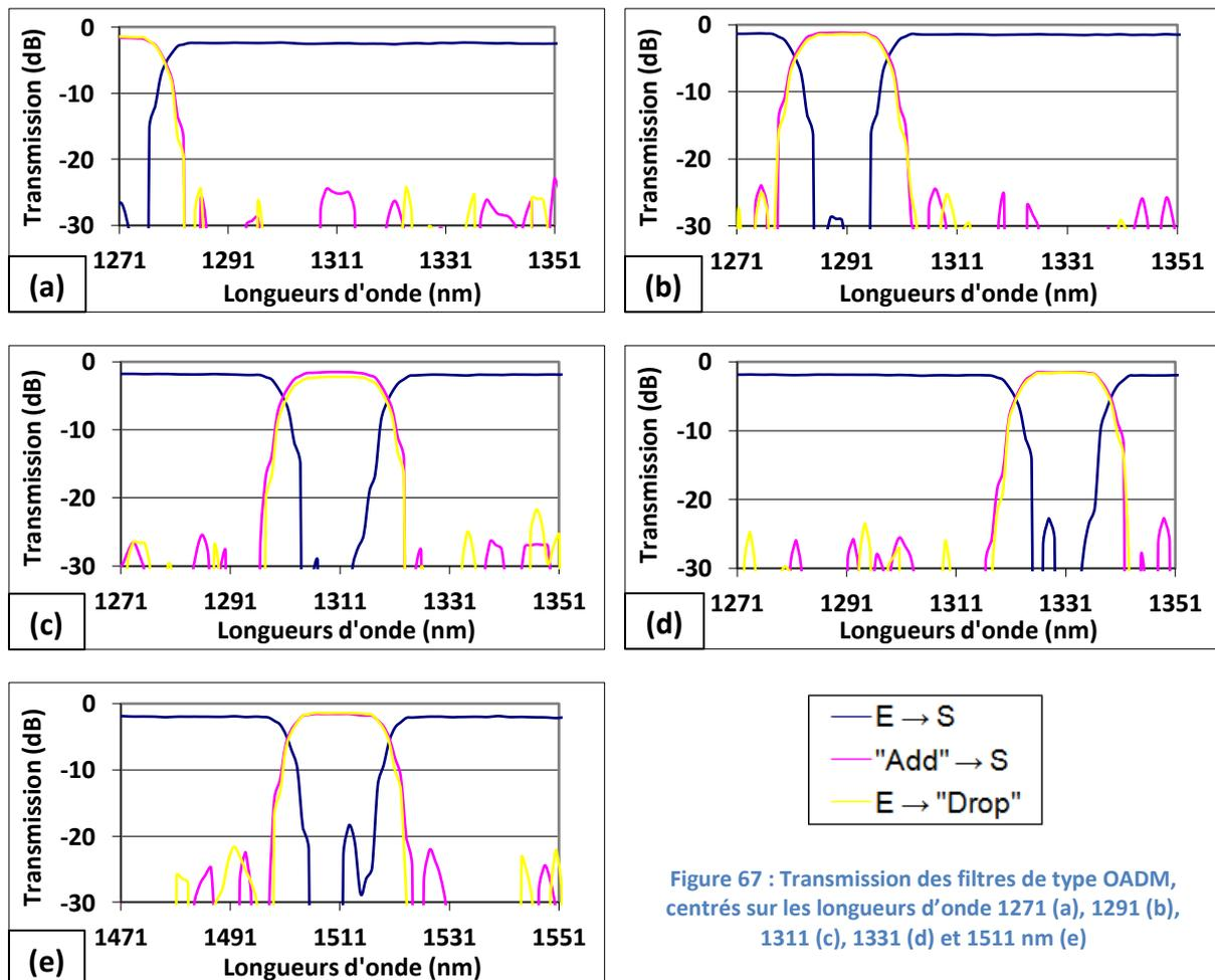
Figure 67 : Transmission des filtres de type OADM, centrés sur les longueurs d'onde 1271 (a), 1291 (b), 1311 (c), 1331 (d) et 1511 nm (e)
