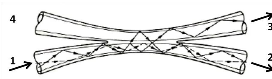
Figure 7 : Schéma du coupleur 2x2 à fusion – étirage [8]
