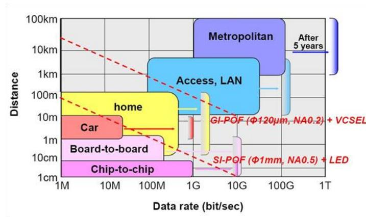
Figure 30 : Caractéristique débit / distance de quelques principaux réseaux [19]
