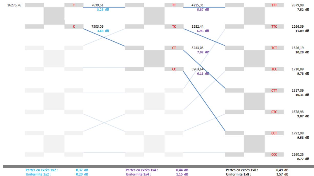
Figure 151 : Performances du modèle de coupleur  $N \times N$  soumis à un faisceau issu d'un VCSEL
