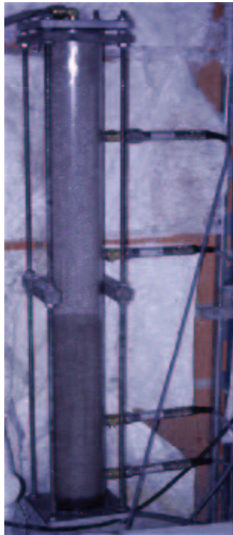
Figure~10-76: Essai d'injection à l'eau. Vue d'ensemble de la colonne. Le front d'eau est nettement visible.
