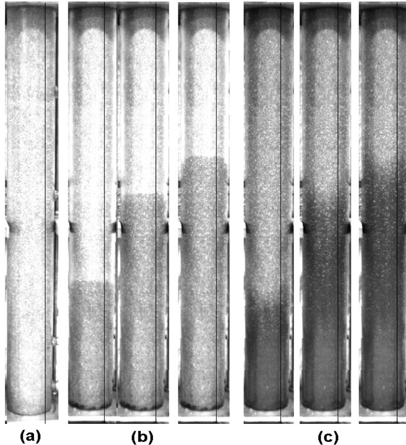
Figure 3-1: Injection d'un coulis de ciment micro-fin dans une colonne remplie de sable du Léman. (a) : sable sec. (b) : saturation à l'eau. (c) : injection au coulis.
