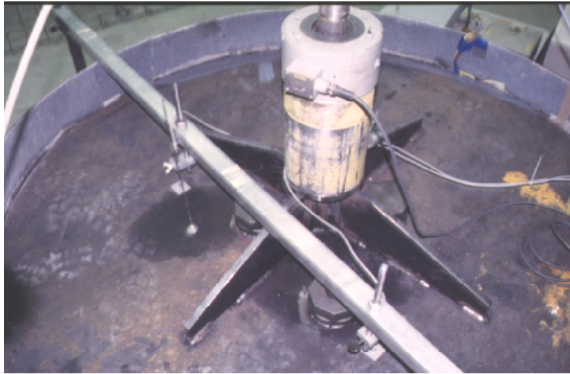
Figure 10-85: Plaque de chargement en acier et vérin hydraulique (effort mécanique).
