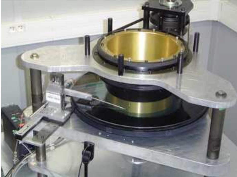
FIGURE 11. Premier banc d'essai avec disque en verre et système de positionnement de la sonde à fil chaud. Le dispositif de forçage est situé au-dessus et est entraîné par un second moteur, indépendant de celui qui met le disque en rotation.
