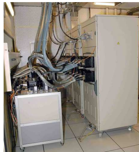
Figure 16 : Emulation à l'aide d'une CAC d'un réseau de bord lors d'un démarrage du moteur thermique. A droite raccordement aux filtres applicatifs.
