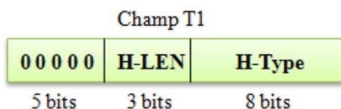
Figure 2.6. Structure du champ TI pour indiquer un entête d'extension ULE
