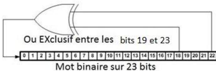
Figure 5.3 : Principe de l'algorithme PRn23
