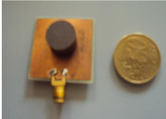
Figure 2.22. Photo d'une antenne à résonateur diélectrique cylindrique
