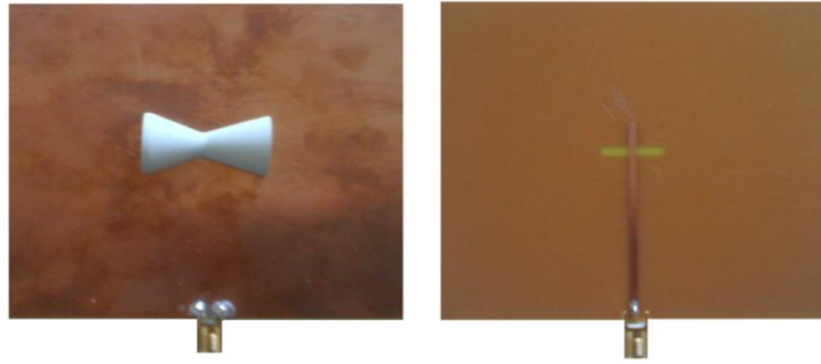
Figure 3.32. Photographie de l'antenne papillon réalisée
