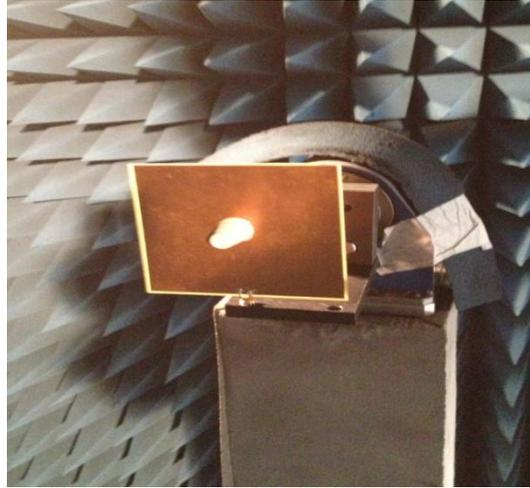
Figure 3.23. Mesures de l'antenne dans la chambre anechoïde de l'ESEO
