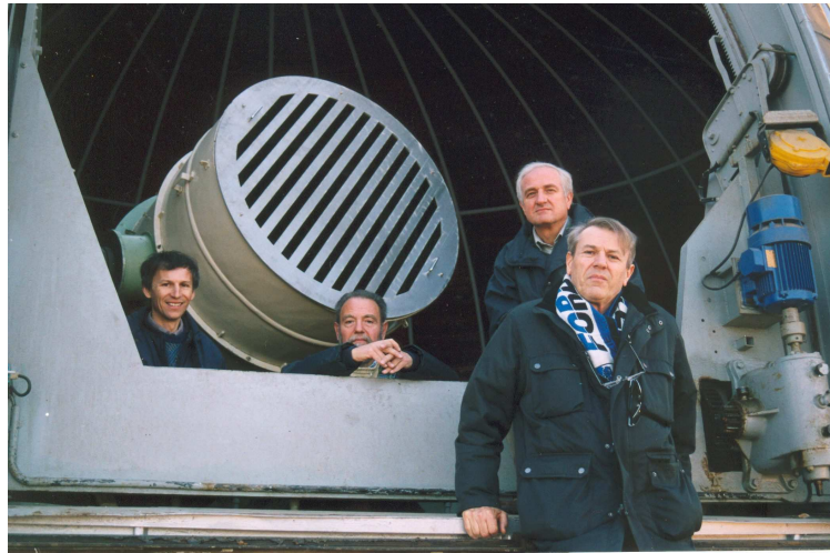
FIG. III.6: Réseau de calibration monté sur le télescope Zeiss de 1m de Merate en Novembre 2005. Ce réseau permet une calibration absolue de l'échelle sur le détecteur de PISCO. De gauche à droite : Jean-Louis Prieur, Marco Scardia, Renzo Valtolina et Luigi Pansecchi.
