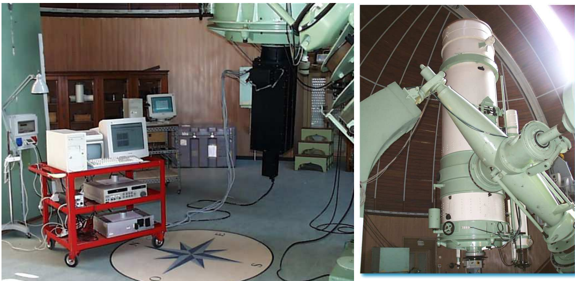
FIG. III.2: PISCO au foyer Cassegrain du télescope Zeiss de 1 m de Merate (Italie).
