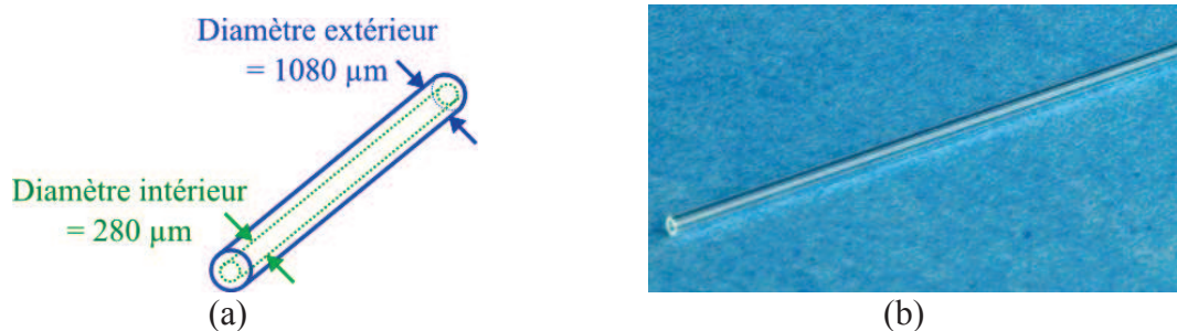
Figure 2. 1 : (a) Schéma du microcanal en verre (b) Photographie du microtube en verre.
