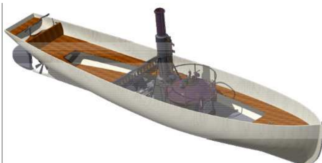
Figure 2.14 – Maquette virtuelle fonctionnelle du Canot à vapeur de 1861 d'après (Laroche et al. , 2010b)
