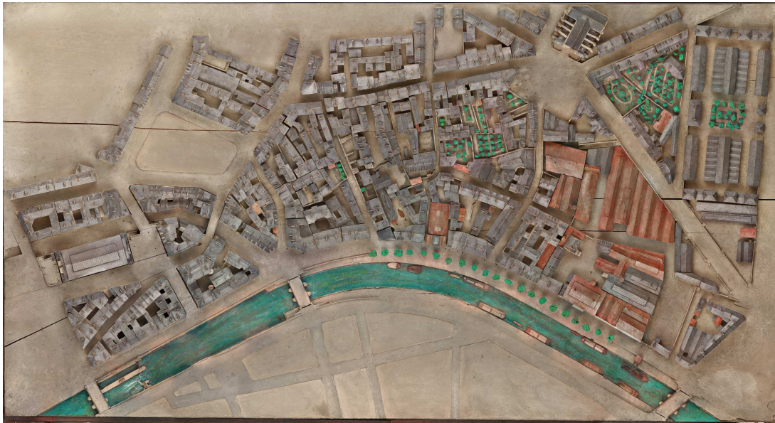
Figure 5.6 – Orthophoto de la maquette Saint-Similien réalisée par photogrammétrie.
