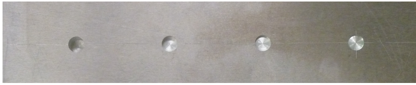
FIGURE 5.8 – Photo des quatre trous à fond plat de diamètre 10 mm percés dans la plaque d'aluminium d'épaisseur 40 mm. Les profondeurs des trous sont respectivement 10, 4, 2 et 1 mm.
