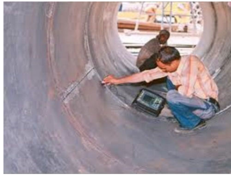
FIGURE 1.1 – Contrôle d'un tube de grand diamètre par ultrasons. La sonde ultrasonore est placée directement en contact avec la pièce par l'opérateur pour l'inspecter (source : IRC Advanced NDT Services, www.indiamart.com ).
