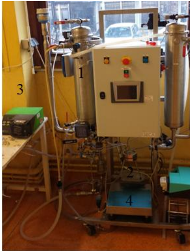
Figure III. 4: Pilote de filtration tangentielle (membrane plane)
