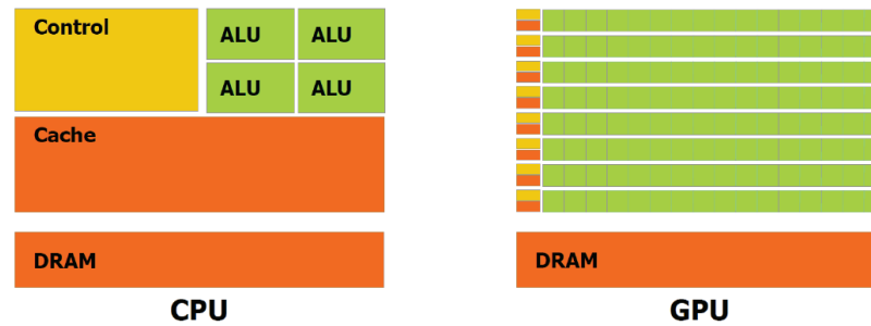
FIGURE 3.1 – Illustration de la différence entre GPU et CPU. Extrait de [Nvidia 12].
