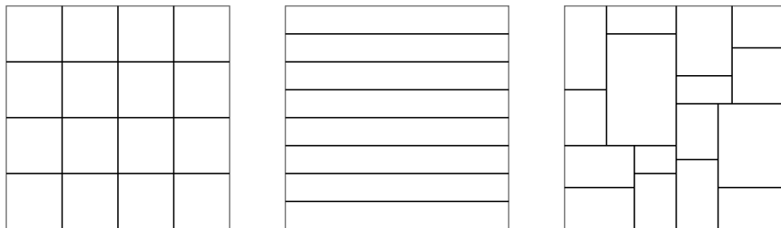
FIGURE 2.10 – De gauche à droite : partitionnement en blocs, en blocs-lignes et bissection récursive orthogonale
