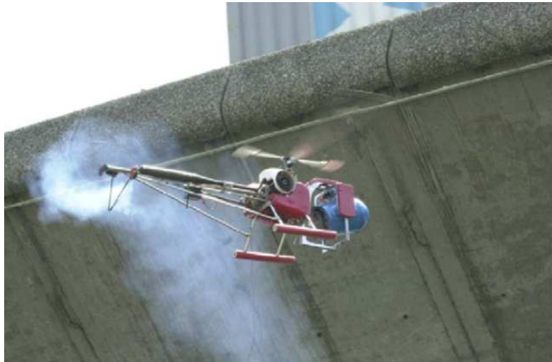
FIGURE 1.21 – L'inspection de ponts et ouvrages d'art est l'application visée dans (Metni and Hamel, 2007), d'où est tirée cette image
