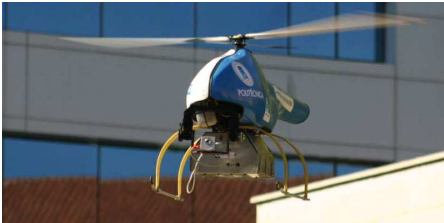
FIGURE 1.18 – Le drone Colibri utilisé pour une application de SLAM présentée dans (Artieda et al., 2009)
