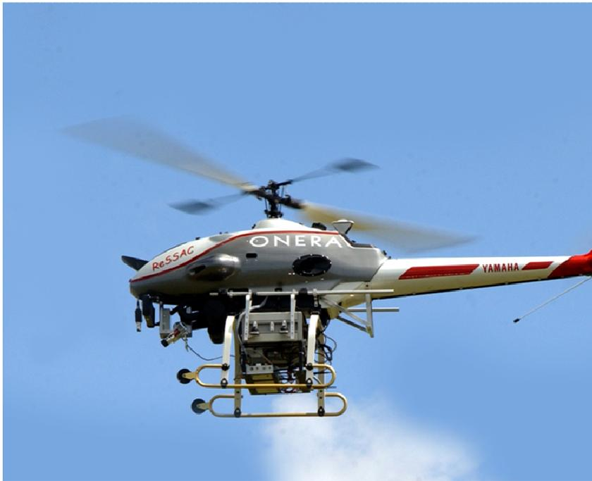
FIGURE 5.2 – Plate-forme expérimentale Rmax
