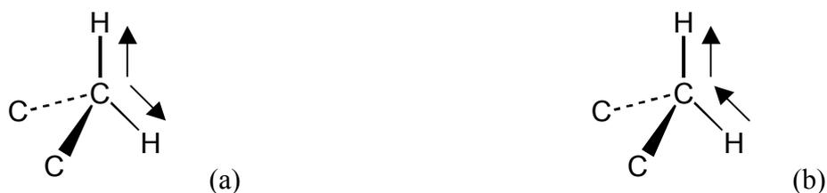
**figure 2.8:** principales déformations des liaisons C-H du méthylène, en (a) vibration symétrique ( $\nu_s$ ), en (b) vibration antisymétrique ( $\nu_a$ ).
