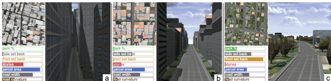
FIGURE 3.11 – Trois configurations bâties générées avec pour objectif (a) un fort ombrage, (b) un ombrage moyen et (c) un ombrage faible (Vanegas et al. , 2012).
