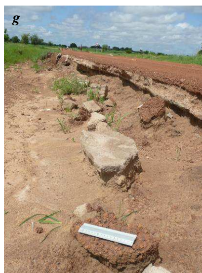
g : Portions de roche dure soulignant l'érosion différentielle à l'œuvre dans les fossés
