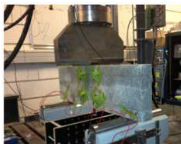
FIGURE 2.11 – Positions des capteurs acoustiques pour les différentes géométries.
