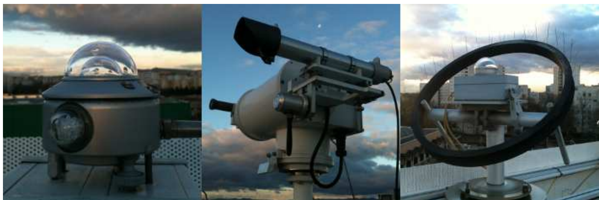
Figure II-11 : pyranomètre (à gauche), pyréliomètre (au milieu) et luxmètre avec arceau pour mesurer le rayonnement diffus (à droite)
