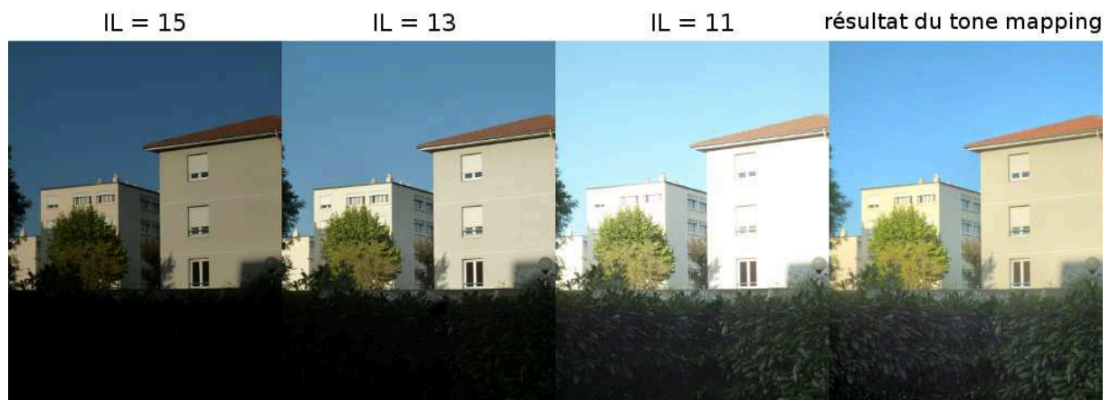
Figure III-1 : Exemple de "tone mapping" d'une image HDR à partir de 3 photos
