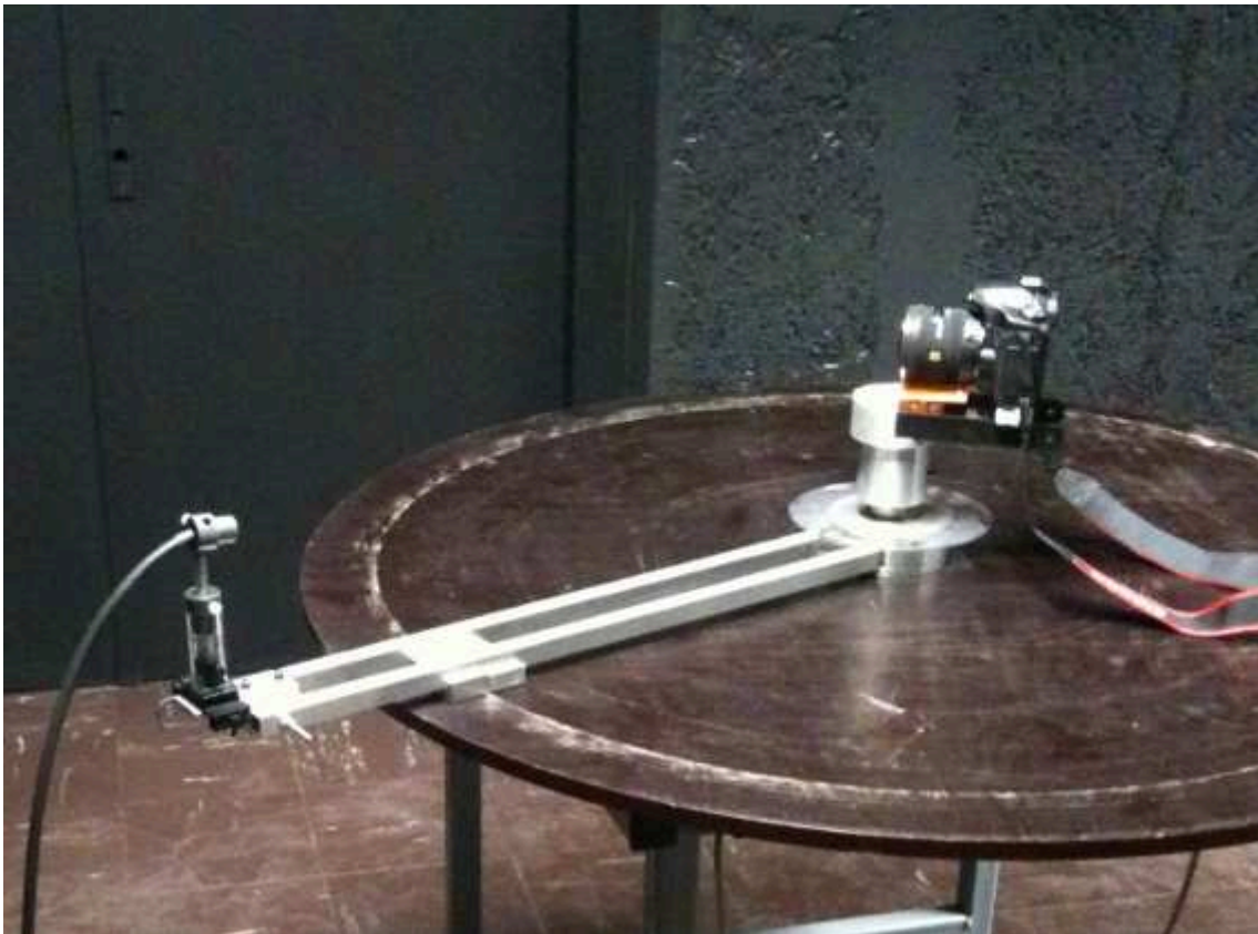
Figure I-1 : Montage pour étalonner l'objectif fisheye
