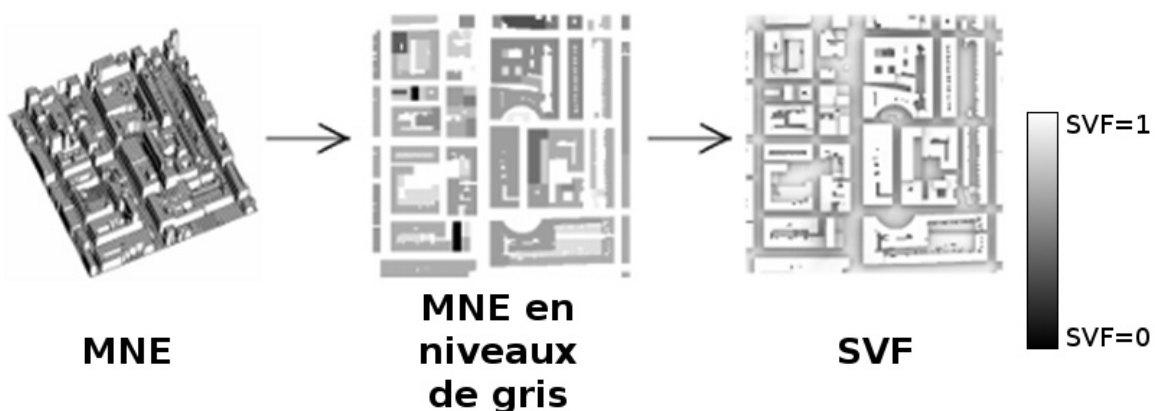
Figure I-29 : Calcul du SVF à l'aide d'un traitement d'image
