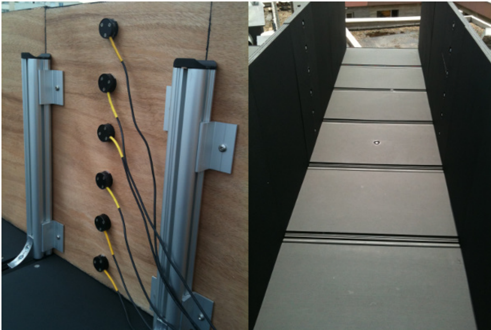
Figure III-52 : Intégration des sondes dans les façades
