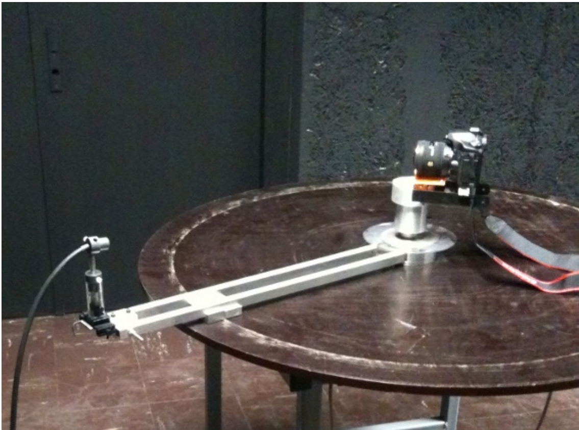
Figure I-1 : Montage pour étalonner l'objectif fisheye
