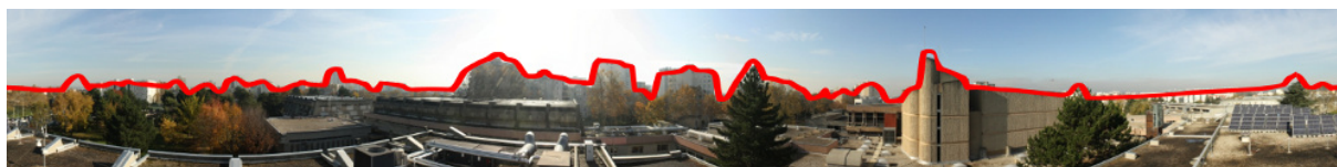
Figure III-47 : Correspondance entre le relief calculé (en rouge) et une photo panoramique centrée sur le sud
