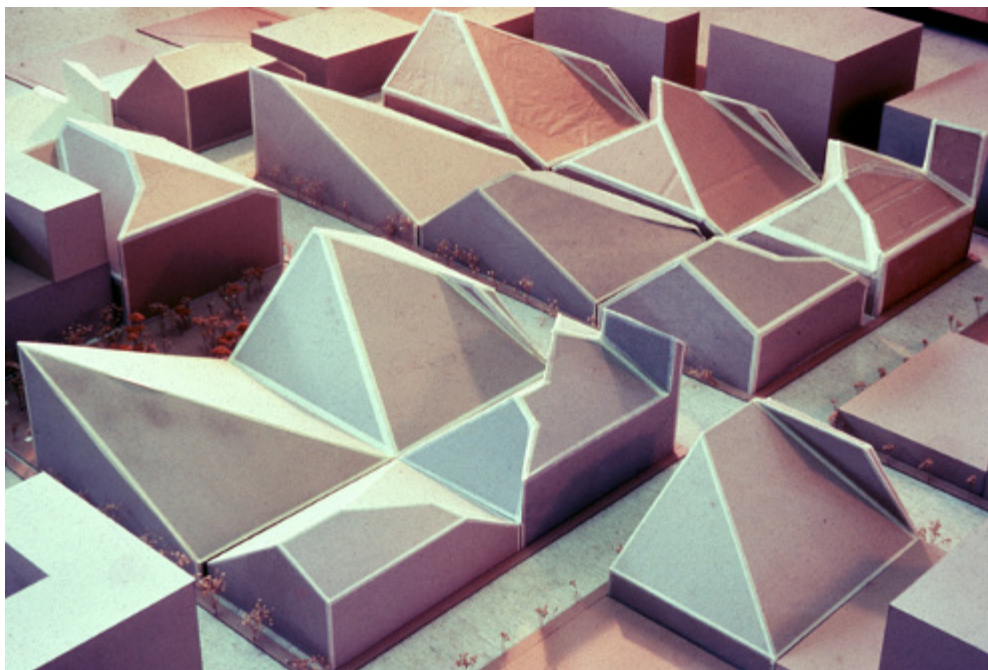
Figure I-7 : Schéma d'un projet d'habitations conçues selon le concept d'enveloppe solaire (Knowles, 2003)
