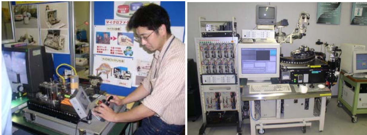
Fig. 2. Prototypes de micro-usines réalisées au Japon : micro-usine de bureau développée au MEL (à gauche) et station d'assemblage de microsystèmes optiques d'Olympus Optical (à droite).
