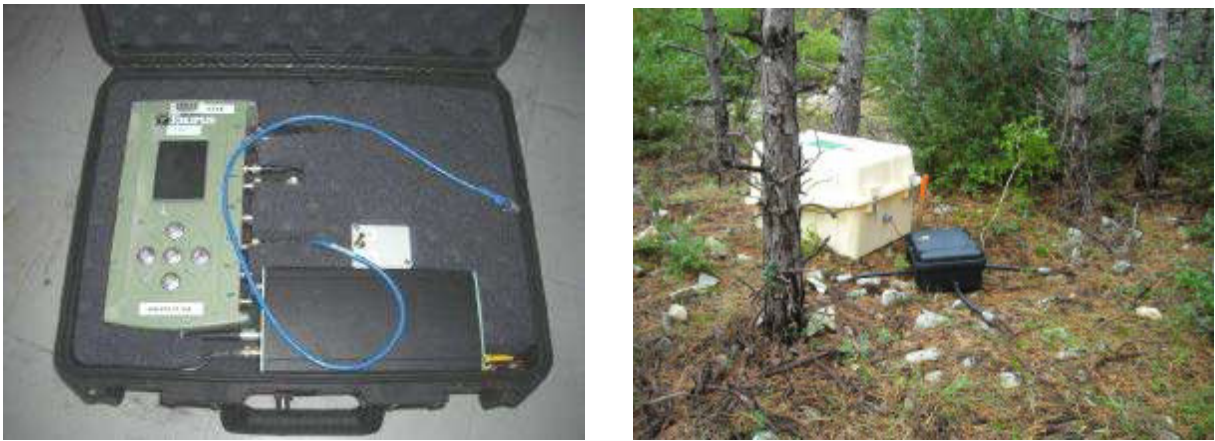
FIGURE 3.17 – A gauche : valise étanche contenant les équipements du microphone. Le boîtier vert est le numériseur. Le microphone est placé sous le numériseur dans le fond de la valise. A droite : exemple d'un point d'acquisition microphone, la boîte blanche contient les batteries d'alimentation.
