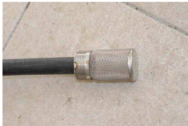
FIGURE 3.14 – Photo d'une crépine placée à l'extrémité d'un tuyau de prise de mesure.
