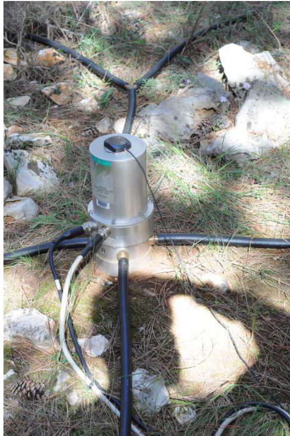
FIGURE 3.13 – Schéma de gauche : système de réduction du bruit de fond pour les microbaromètres. Photo à droite : Microbaromètre avec tuyaux au bout desquels est mesurée la pression acoustique.
