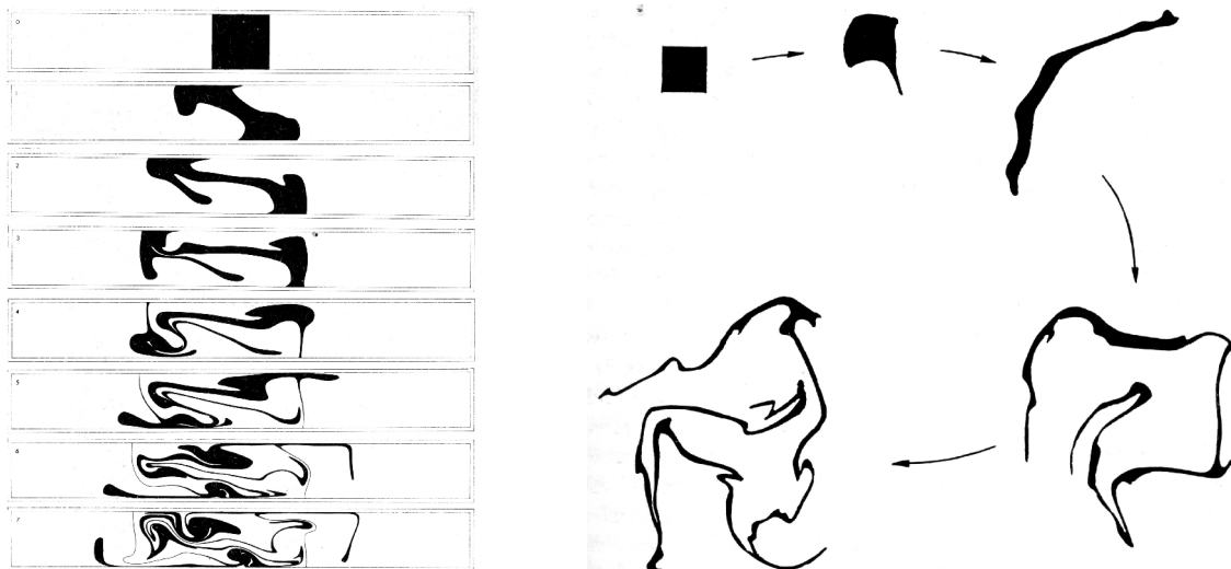
Figure 10 : Déformations de figures géométriques (étirements et réorientations des éléments de fluide) (Ottino [4])
