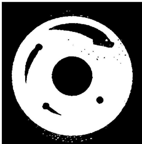
Figure 1 : Identification de la zone d'écoulement par seuillage des données expérimentales Le niveau du seuil est de 50000, ce qui représente 25 % de la valeur maximale observée
