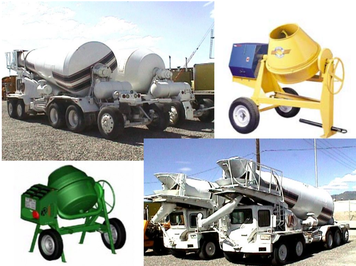
Figure 5 : Camions de malaxage et bétonnières
