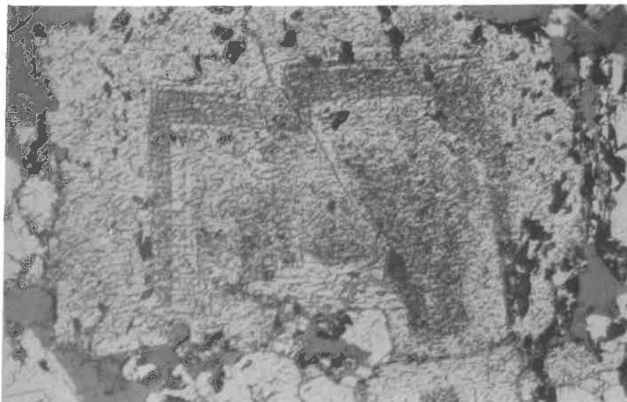
Photo 17. Inclusions (spinelles) soulignant la forme cristalline de la magnétite. X 180.
