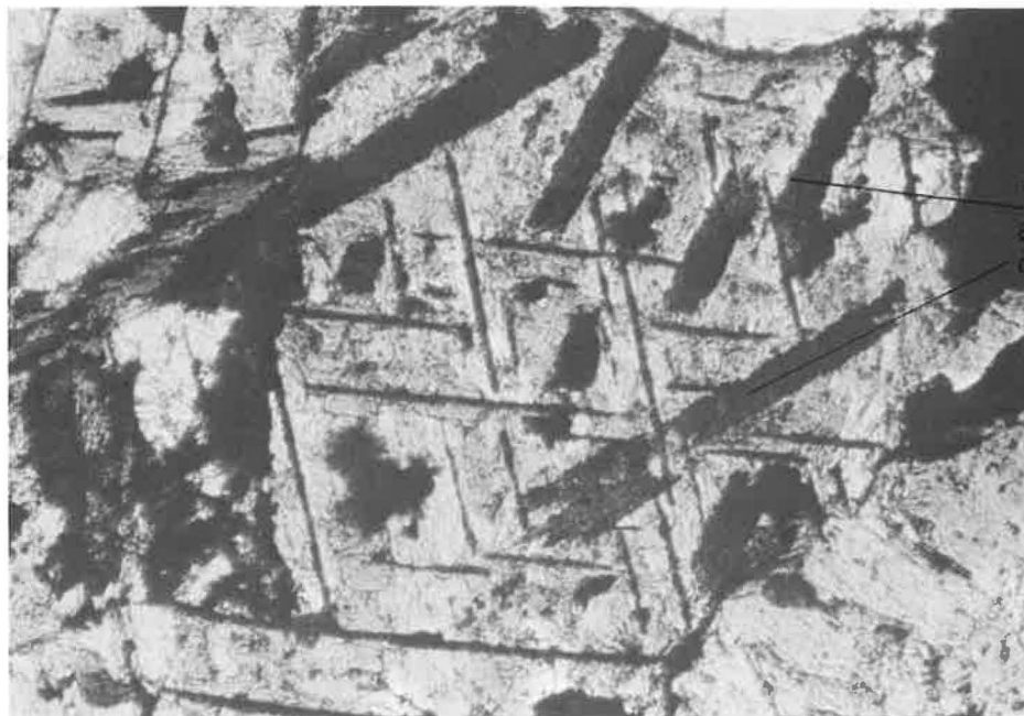
Photo 13. Magnétite chloritisée (lumière transmise)
