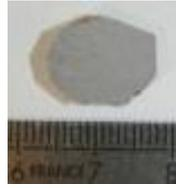
**Figure 43 : Echantillon de pâte de CEM V/A destiné aux essais de porosimétrie par intrusion de mercure.**
