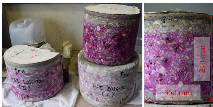
Figure 38 : Carottes de béton, à base de ciment Portland, prélevés sur le bâtiment 158 du CEA Saclay – Mise en évidence de la zone carbonatée.
