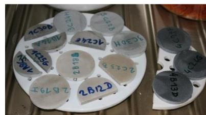
**Figure 114 : Échantillons utilisés pour les mesures de porosité accessible à l'eau.**
