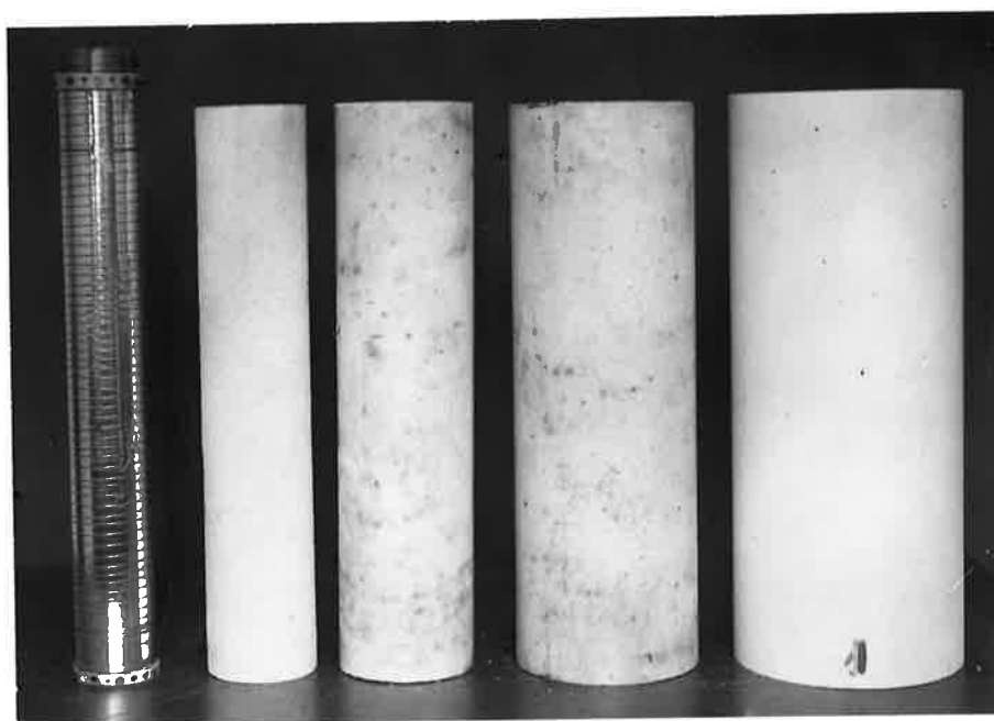
FIGURE 19 - Ecrans coaxiaux en alumine et noyau démontable pour la mise en place de l'enroulement chauffant.
