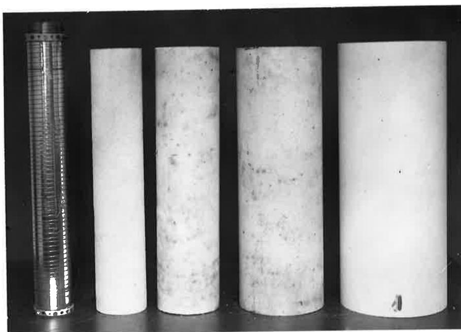
FIGURE 19 - Ecrans coaxiaux en alumine et noyau démontable pour la mise en place de l'enroulement chauffant.
