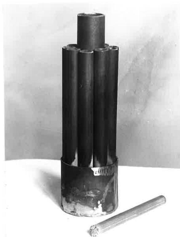
FIGURE 7 - Lingotière pour coulée en source et lingot obtenu après démoulage.
