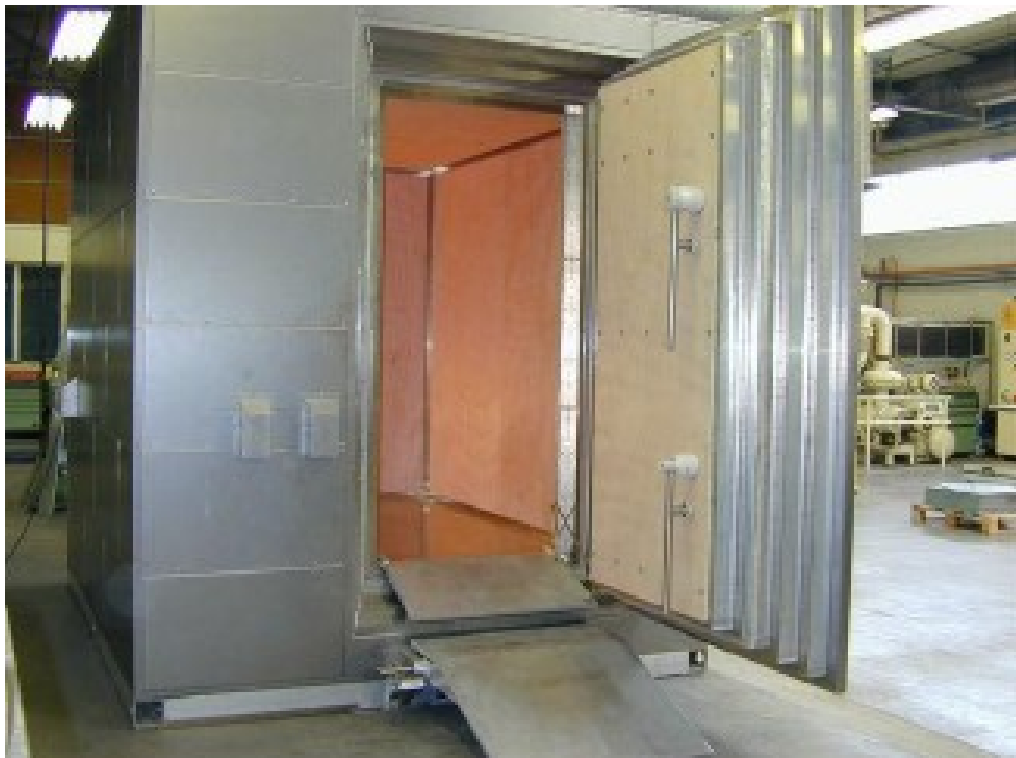
Figure 3.1 : Chambre blindée du laboratoire utilisée pour nos caractérisations.
