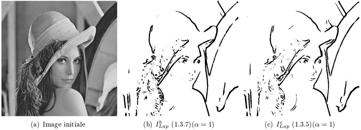
FIGURE 1.5 – Segmentation par le GT associé à un domaine (b) perforé et (c) fissuré pour (a) une image non bruitée
