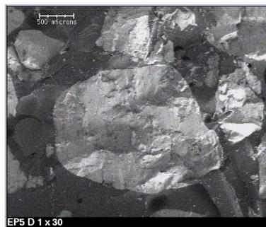
FIG. 3.29 – Micrographie d'une rupture de granulat observée au niveau de la zone de rupture d'un échantillon composé de gravier et de résine.
