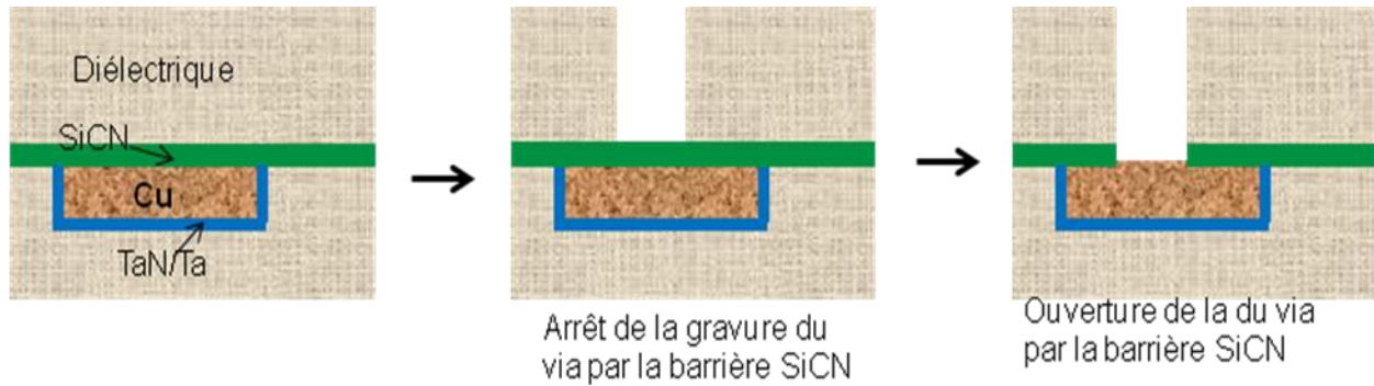
Figure 1-5 : Rôle de la barrière diélectrique lors de la gravure
