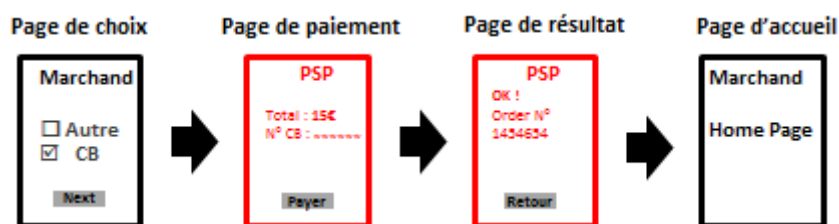
FIGURE 4.10 – Cinématique n°1 : l'E-commerçant délègue l'affichage du ticket de paiement à son prestataire de paiement bancaire
