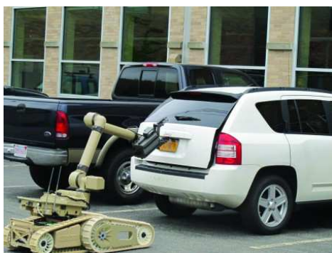
FIGURE 1.3 – iRobot-710-Warrior : robot chenillard téléopéré, équipé d’un bras et d’une pince
