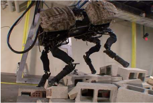
FIGURE 1.5 – BigDog : robot quadrupède tout terrain développé par Boston Dynamics
