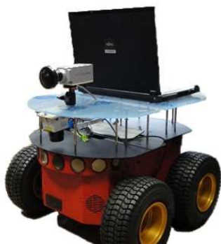
FIGURE 1.1 – Pioneer : robot quadricycles développé par Adept MobileRobots
