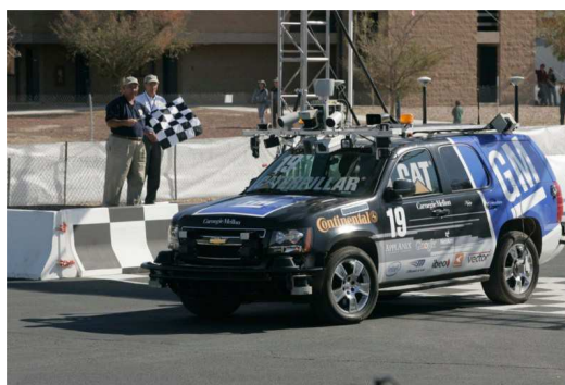
FIGURE 1.2 – Tartan Racing’s Boss : voiture robotisée vainqueur du “Darpa Grand Challenge 2007” (course de véhicules autonomes en milieu urbain).
