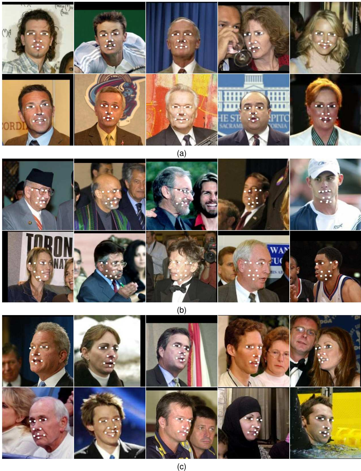
FIGURE 2.7: Exemples de résultats pour la localisation de points-clés (a) Résultats correspondant à l'erreur moyenne la plus faible. (b) Résultats correspondant à l'erreur moyenne la plus forte. (c) Résultats correspondant à l'erreur la plus faible avec une déviation |d_{nez}| > 0.3 (voir le texte).
