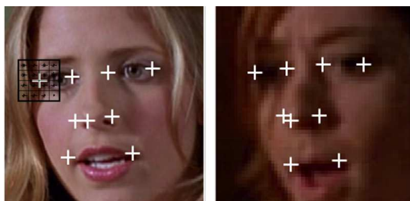
FIGURE 3.5: Les descripteurs de visage sont des descripteurs SIFT calculés sur 9 points-clé du visage à 3 échelles différentes.
