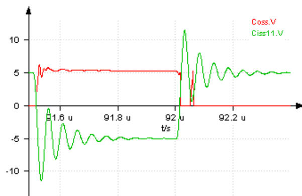
Figure 166 : Simulation du montage Buck avec une tension d'entrée de 5V et un courant d'entrée de 0.45A.
