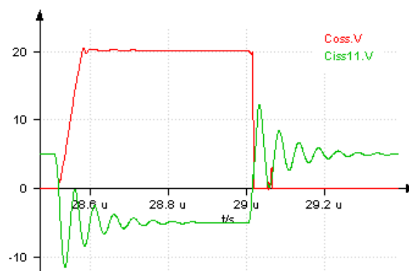
Figure 168 : Simulation du montage Buck avec une tension d'entrée de 20V et un courant d'entrée de 0.21A.
