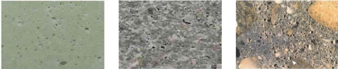
FIG. 3 – Échelle mesoscopique : pâte de ciment, mortier et béton
