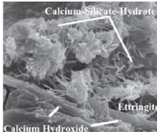
FIG. 2 – Échelle microscopique : plaquettes de  $Ca(OH)_2$ , gel de CSH et ettringite (d'après [Stutzmann, ])
