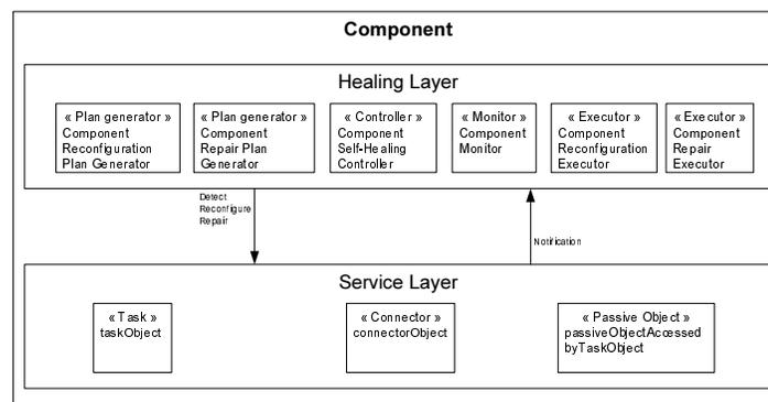
FIG. 3.8 – Architecture des composants « self-healing », Shin (2005).
