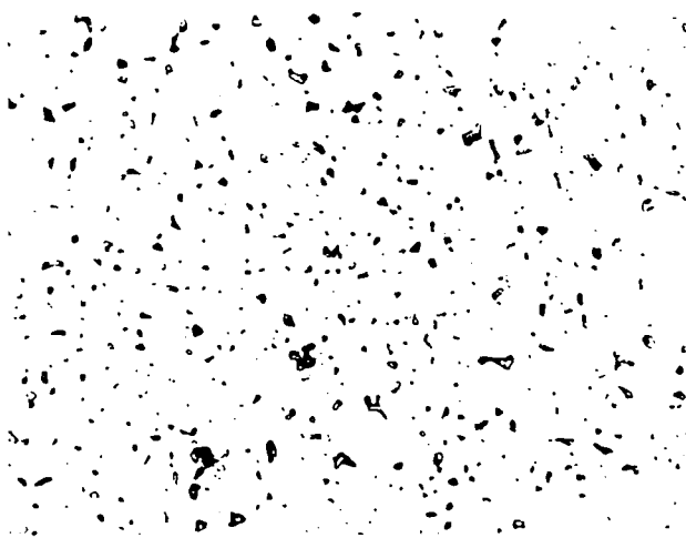
Figure 1. - Porosité du TiB_2 - 10\text{ }\mu\text{m}
